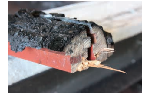
上の画像は 20 分間の遮炎試験直後の部材断面。加熱面は燃えて炭化しているが、内部や非加熱面はきれいに残る。
